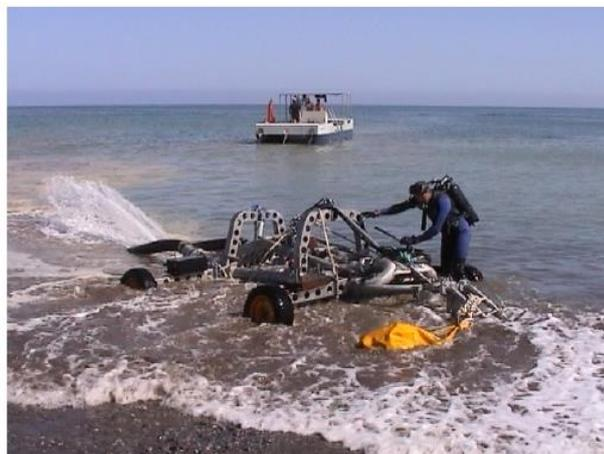
*Figura 11): Esempio di macchina a getti utilizzata da OTS*
