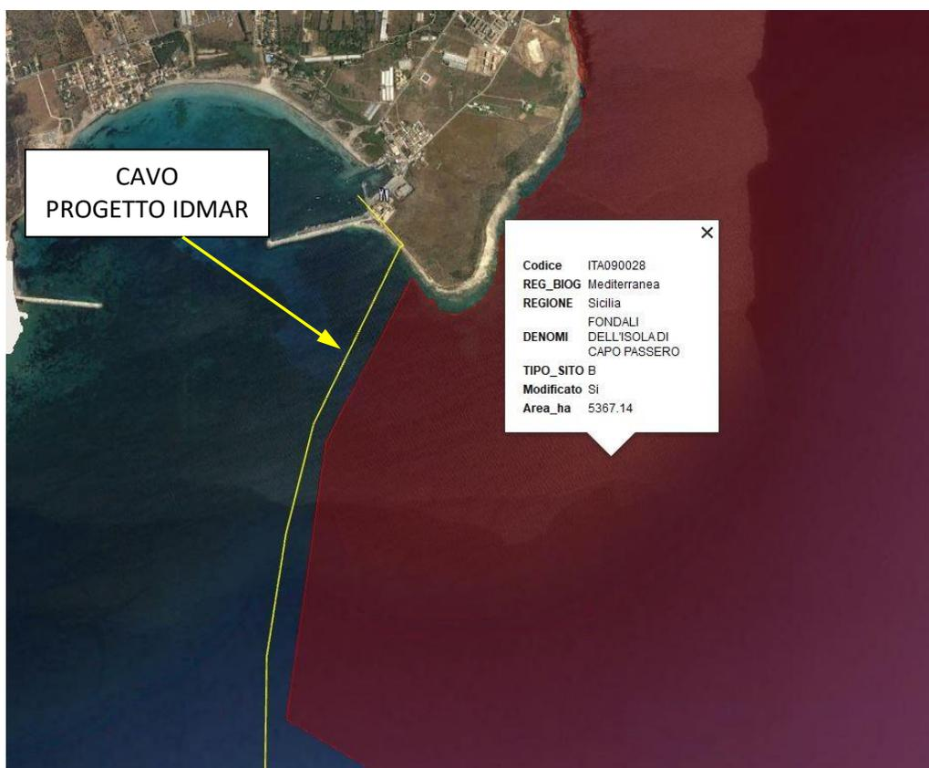
Fig. 1) sviluppo del cavo parallelo al SIC
